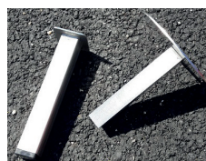
Fourreau et tige d'ancrage avec platine
