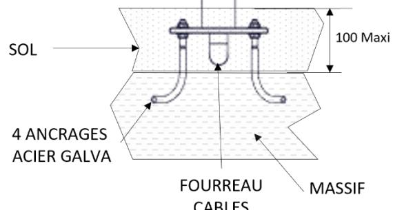
Câblage par la face inférieure du boîtier.
