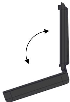
En position ouverte la face avant fait un angle maximum de 110° avec le corps monté sur un support. Le pivotement doit s'effectuer sans forcer.
