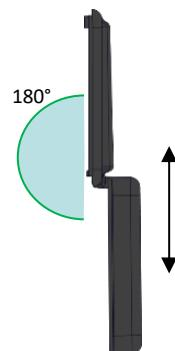
L'insertion et l'extraction de la face avant nécessite le démontage du signal de son support. A 180° l'insertion et l'extraction de la face avant ne doivent montrer aucune résistance.
