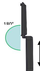
L'insertion et l'extraction de la face avant nécessite le démontage du signal de son support. A 180° l'insertion et l'extraction de la face avant ne doivent montrer aucune résistance.
