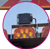
Radar à modulation de fréquence sur équipement de toit
