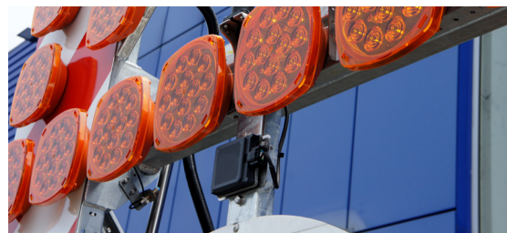
Radar à modulation de fréquence installé sur de la signalisation lumineuse remorquée
