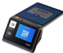
Générateur / valideur de tickets
